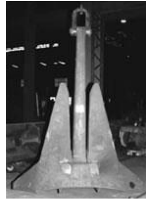
D A-1 型 (中村技研工業で開発したアンカー)
